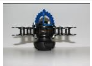
#7 – Stålfreser med kraftkæde monteret på rotor.
