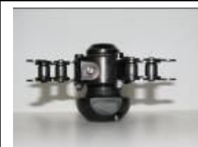
#5 – kraftkæder monteret på rotor.
