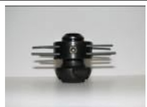
#8 – Rotor monteret med børster.
