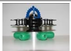
#11 – Stålfreser med kraftkæde monteret på rotor, med alustyr.
